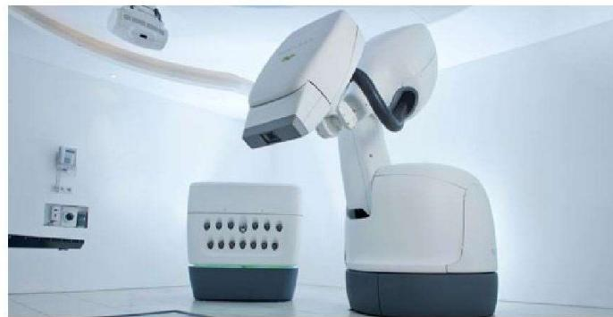
Abb. 1: Das Cyberknife M6, ein robotergestützter Linearbeschleuniger
